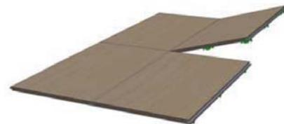
**Pavimento Deportivo Desmontable** y portátil de madera flotante flexible compuesto por pavimento de madera multicapa de de 15 mm de espesor total, apoyada en madera contrachapada abedul, barrera anti-vapor aglomerado en película polietileno. Base de apoyo en espuma de poliuretano flexible.
